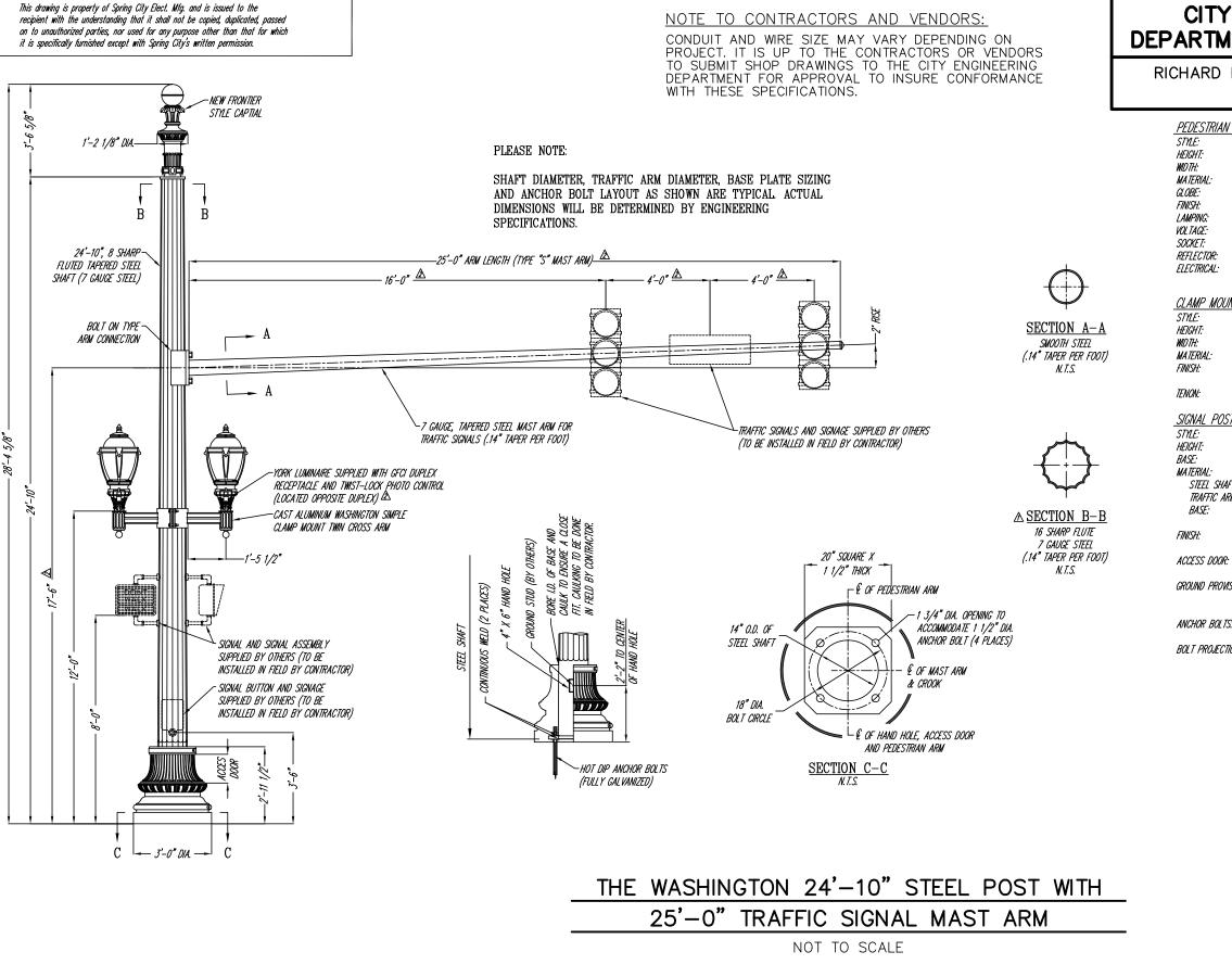
STEEL POSTS AND SIGNAL MAST ARM
